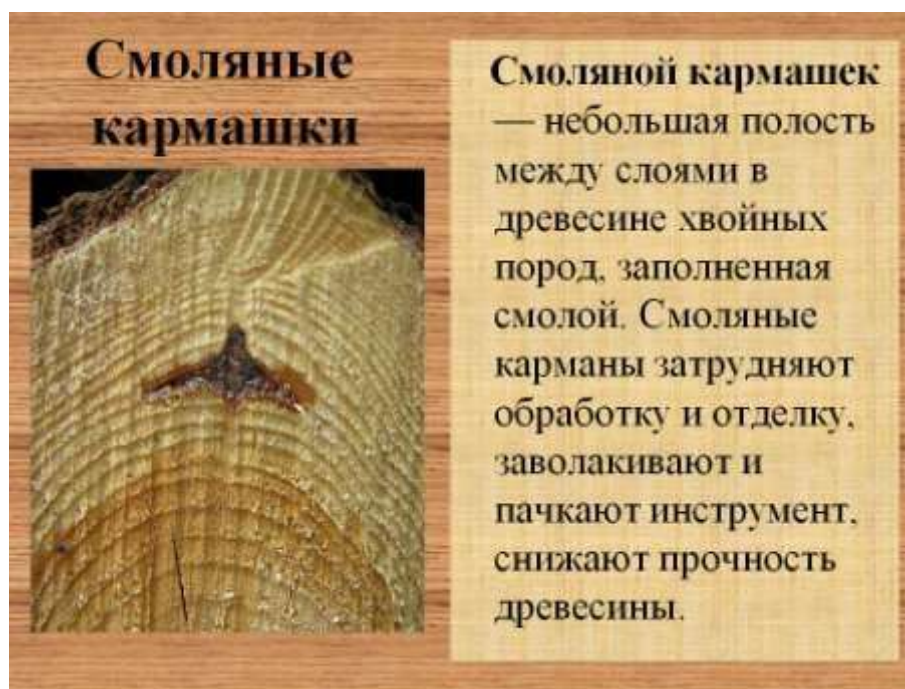
Рис.5 Смоляной кармашек древесины
